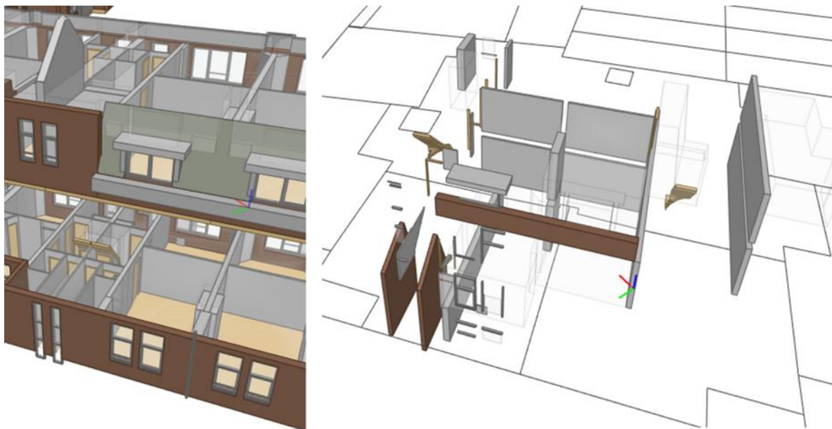
Afbeelding 7. Links het originele BIM-model, en rechts de resterende BIM-objecten van het BIM-model die niet aanwezig zijn in de puntenwolk.
